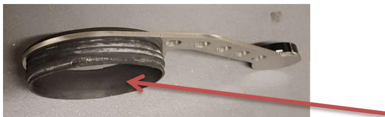
Den Gummispannring in den Halter montieren ggf. im inneren etwas leicht Creme einschmieren, dann rutscht es besser über das Uhrengehäuse.
