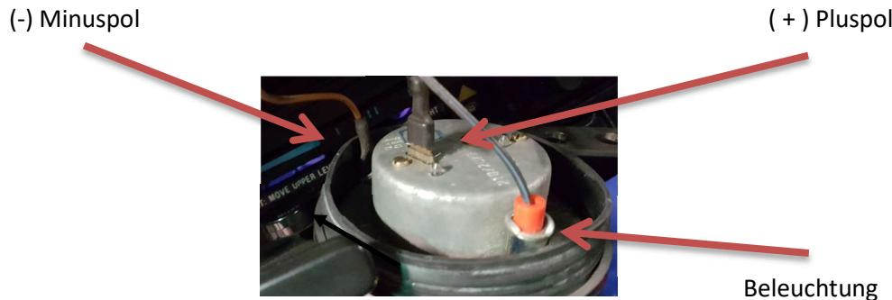
Abb. Anschluss der Uhr
